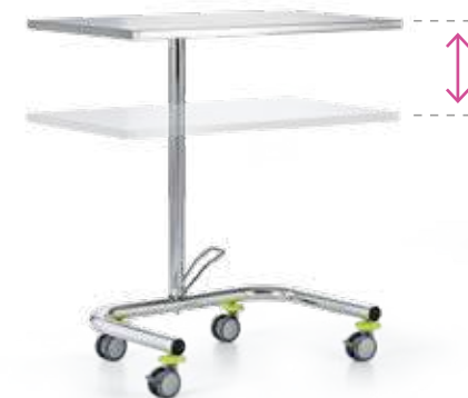
9CI0216 Carrello portastrumenti chirurgici, oleodinamico, piano in acciaio Inox AISI 304. Colonna con sollevatore oleodinamico a pedale. Basamento in acciaio Inox AISI 304 con quattro ruote gemellari antistatiche diametro 100 mm di cui due con freno. Dimensioni: totali 1200 x 700 x 950/1300 (h) mm Hydraulic surgical instrument cart with AISI 304 stainless steel top. Pedal-operated hydraulic stand. AISI 304 stainless steel base with four 100 mm diameter antistatic twin swivel castors, two braked. Dimensions: 1200 x 700 x 950/1300 (h) mm
