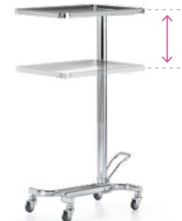
9CI0109 Carrello porta ferri oleodinamico, piano superiore a vassoio in acciaio Inox AISI 304 satinato. Basamento in profilo di acciaio cromato con ruote piroettanti antistatiche diametro 60 mm. Sistema di sollevamento oleodinamico azionato da pedale a circuito sigillato. Dimensioni: interne del vassoio: 665 x 440 x 26 (h) mm Dimensioni: 650 x 4665 x 900/1250 (h) mm Hydraulic serving cart with top tray made from satin-finished AISI 304 stainless steel. Base made from chrome-plated steel struts with four 60 mm diameter antistatic swivel castors. Internal tray dimensions: 665 x 440 x 26 (h) mm. Dimensions: 650 x 4665 x 900/1250 (h) mm
