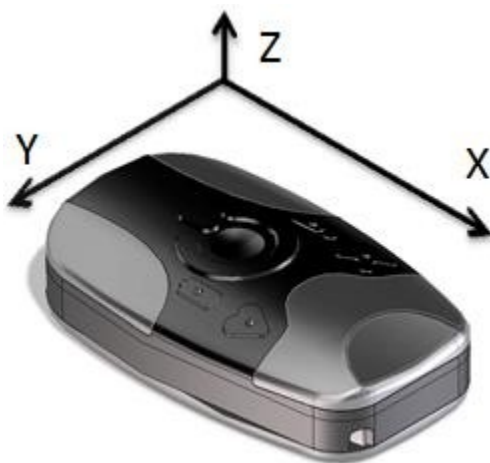
Рисунок 13 Напрямки осей акселерометра
